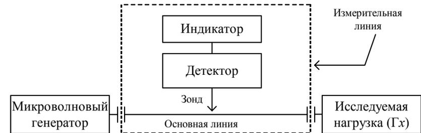
Рисунок 3.12 — Схема измерения параметров нагрузки с помощью измерительной линии
