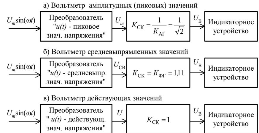
Рисунок 3.4 — Упрощенные структурные схемы электронных вольтметров
